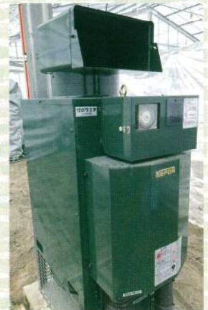
写真④ 炭酸ガス発生機
